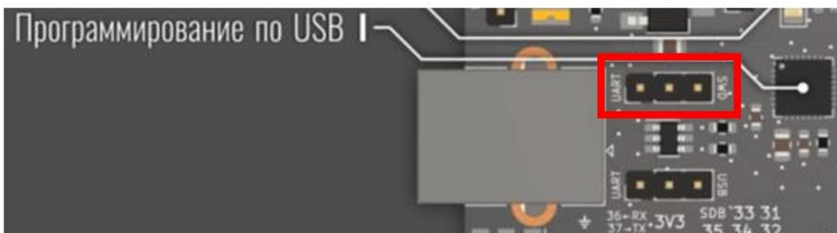
В данном положении контроллер ожидает загрузки новой программы. Если вы хотите, чтобы при подключении USB кабеля сразу выполнялась загруженная ранее программа, то установите перемычку в другое положение.
