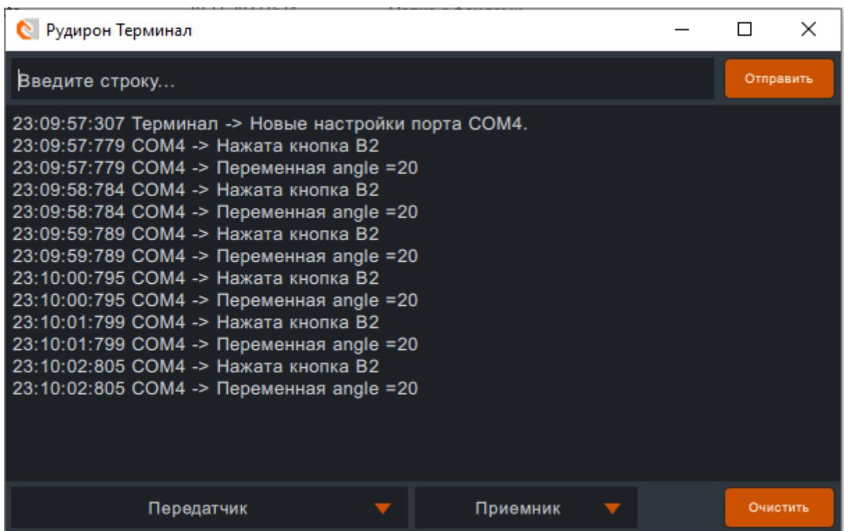
Терминал и сам UART позволяет нам передавать в контроллер информацию. Напишем программу, которая принимает от компьютера 1 или 0. Если приняли 1, то включаем светодиод L1. Если принимаем 0, то выключаем L1.
