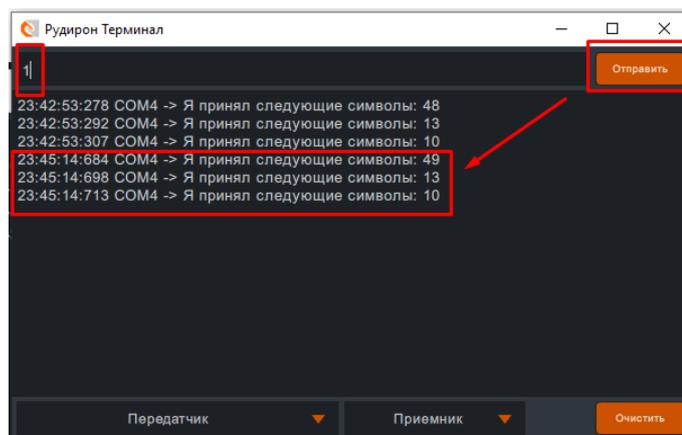
Программа работает корректно. При передаче символа 1 светится светодиод L1 при передаче символа 0 он гаснет.
