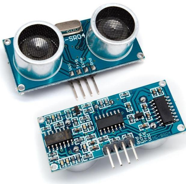
Ультразвуковой датчик расстояния (дальномер) HC-SR04 - может измерять расстояние при помощи ультразвука.
